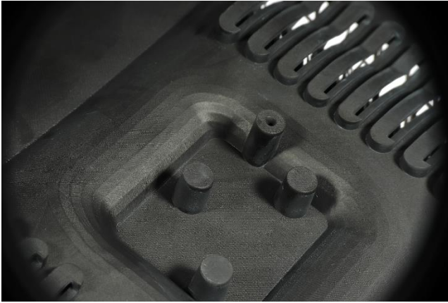
Detailansicht des 3D-gedruckten Gehäuses mit Lüftungsschlitzen und Öffnungen für Kabel und Elektronik
