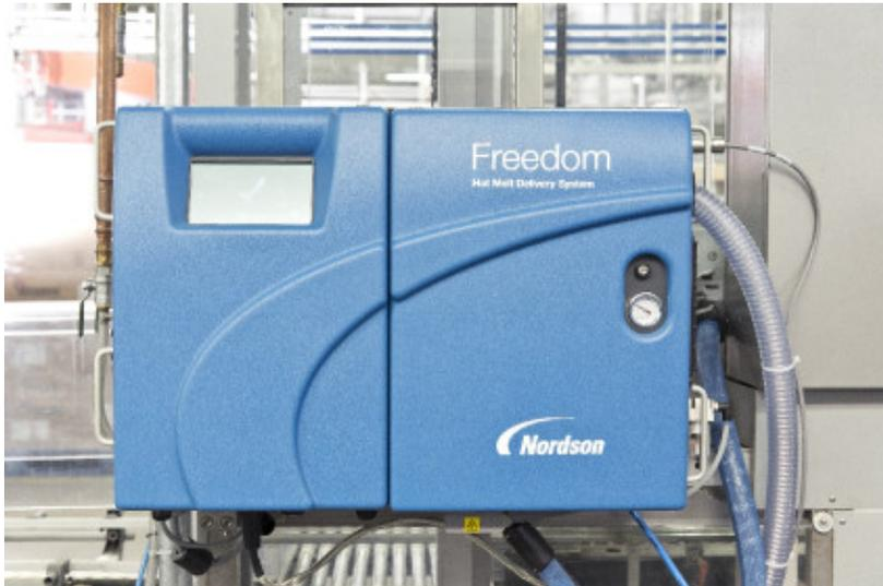
Das „Freedom™“-System kombiniert speziell entwickelte Schmelzklebstoffe von Technomelt mit einer hochwertigen Präzisionsdosieranlage, die diese Klebstoffe bedarfsgerecht auf Verpackungen aufträgt.
