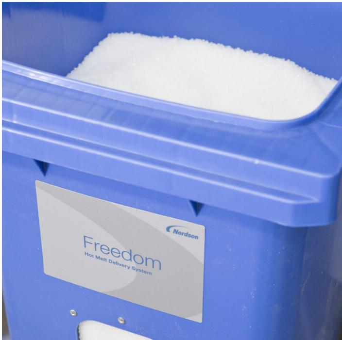
Das Schmelzklebstoff-Granulat wird von der Präzisionsdosieranlage aus dem Vorratsbehälter angesaugt und dabei erst unmittelbar vor dem Auftragen erhitzt. Das verbraucht deutlich weniger Energie.
