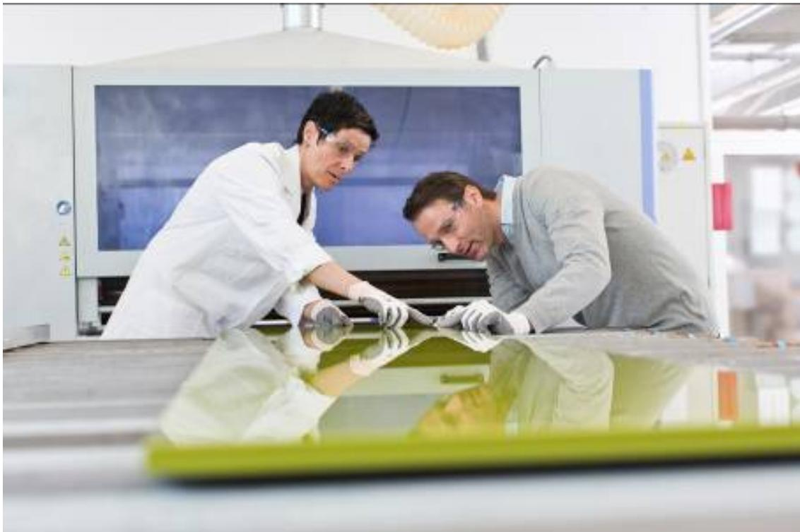
Beim „Fusion Coating“ wird der UV-härtende Hotmelt Technomelt CHS 370 UV direkt auf die melaminharzbeschichtete Holzwerkstoffplatte aufgetragen und dient dann als Basis für eine oder mehrere weitere Lackschichten, die schließlich für den Hochglanzeffekt sorgen.
