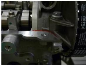
Das Herausquellen des Dichtungsmittels an der Verbindung mit dem Nockenwellendeckel und seine Rheologie ermöglicht eine sofortige Beständigkeit der Abdichtung.
