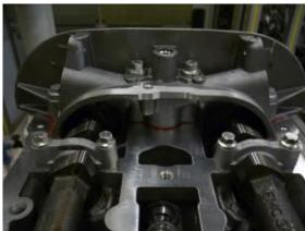
Stark beanspruchte Verbindungen der Ford 1,0-Liter und 1,6-Liter EcoBoost-Motoren werden mit dem anaeroben Flanschdichtungsmittel von Henkel abgedichtet.
