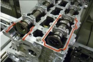
Loctite 5189 dichtet hochbeanspruchte Verbindungen in den 1,6-Liter EcoBoost-Motoren von Ford ab, etwa bei der Halterung der Einspritzpumpe und der Vakuumpumpe. Das anaerobe Dichtungsmittel ist hochflexibel auch nach Wärmealterung und eignet sich damit für dynamische Verbindungsstellen.
