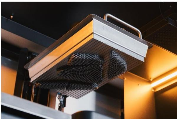
Funktionale Lattice-Struktur für die Sitzherstellung von KTM-E Technologies, die von GENERA mit Loctite 3D 8195 gedruckt wird.
