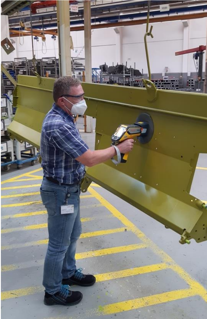
Messung des Beschichtungsgewichts der ZnPO 4 -Schicht durch die KTL-Schicht bei Claas Bad-Saulgau.
