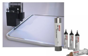
スマートフォン、タブレット、PC 等の筐体の接合用として採用実績がある LOCTITE(ロックタイト)反応性ホットメルト構造用接着剤。ウレタンプレポリマーをベースとし、湿気による三次元架橋を形成し再溶融しません。構造用両面テープと比べ接着強度が高く、貼り付け工程の自動化が可能のため両面テープを用いた場合と比べ、生産効率の向上が見込めます。防水性も高く、極細塗布や異形状、段差への塗布にも対応。ブース内の動画でどのような塗布が可能かご確認いただけます。
