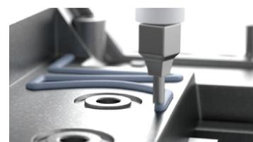
電子機器の高熱伝導・長期信頼性を実現し、自動化によるトータルコストダウンを可能にするヘンケルの熱マネジメント材料。熱伝導接着剤(テープ/フィルム/液状)、熱伝導材料(薄型パッド/ギャップ充填材料/フェーズチェンジ材料/グリース)、熱伝導低圧成形材料と幅広いラインナップを取り揃え、熱管理における様々な要求事項に対応します。各種材料の特長はブース内資料・動画にて紹介します。
