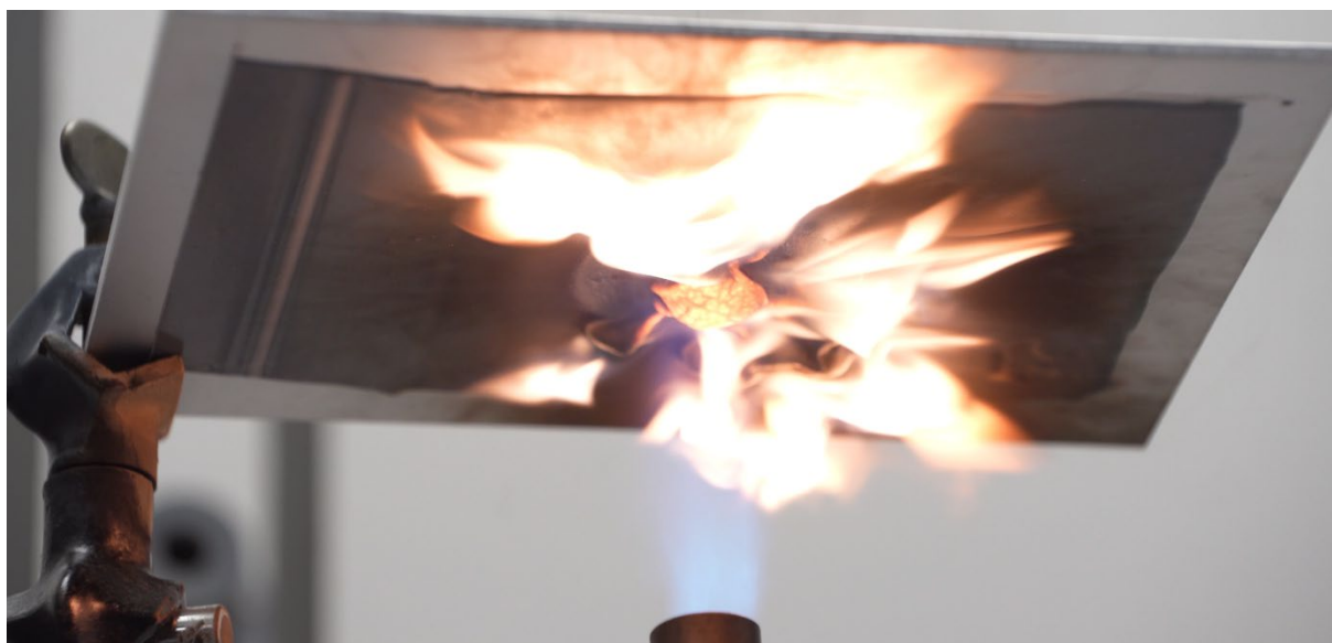
直火試験(耐火コーティング製品の性能試験にヘンケルが用いる試験方法の一つ)の実施中に撮影
