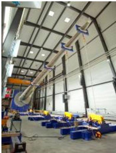
Den Langzeittest unter höchsten Belastungen haben die geklebten Verbindungen erfolgreich bestanden. Das IWES hat das 40 Meter lange Rotorblatt gemäß der IEC Norm 61400-23, die zur Überprüfung der Nennbelastbarkeit und Ermüdungserscheinungen in statischen und dynamischen Tests dient, überprüft.
