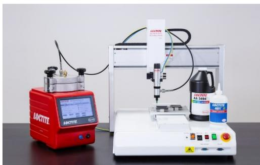
Los equipos van de manuales a automáticos y robotizados, de unidades estándar a sistemas llave en mano hechos a medida, para osificar una amplia variedad de adhesivos, selladores y recubrimientos.
