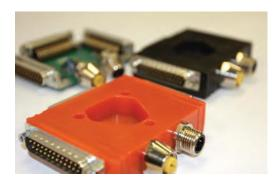
Die innovativen Schmelzklebstoffe lassen sich durch einen Formguss in jede gewünschte Form gießen. Dabei können sie sich auch mit anderen Bauteilen wie elektronischen Netzsteckern verbinden und so zu einem Endprodukt werden.
