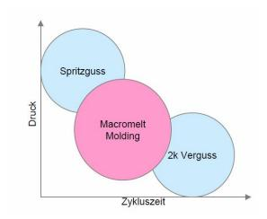
Das Hotmelt Moulding-Verfahren ordnet sich zwischen dem Spritzguss und dem Zweikomponentenguss ein und verbindet damit die positiven Eigenschaften aus beiden Prozessen.
