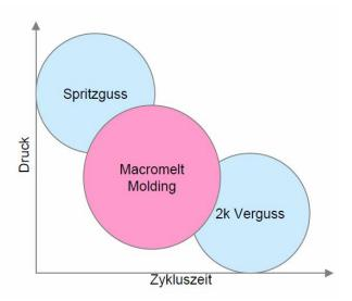
Ein weiterer Vorteil des Hotmelt Moulding-Verfahren ist, dass keine Aushärtung im Ofen erforderlich ist. Auf diese Weise reduziert sich der Flächenbedarf der Anlagen auf unter zwei Quadratmeter. Ein zusätzliches Gehäuse entfällt ebenfalls, da der Hotmelt eine schonende Ummantelung bildet und das Bauteil auf diese Weise schützt.
