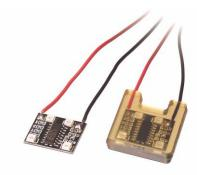
Durch das Niederdruck-Spritzgussverfahren lassen sich auch empfindliche elektronische Bauteile mit einem Schmelzklebstoff ummanteln, so werden diese vor schädlichen Umwelteinflüssen geschützt.
