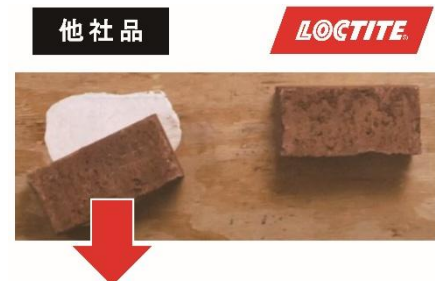
【初期保持力比較】ブロックに接着剤を塗布後、壁に10秒押さえた後のイメージ（社内試験）
