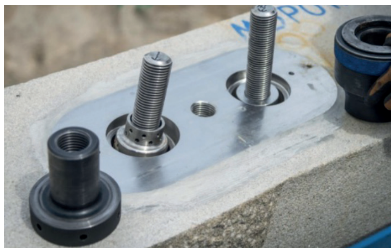
Ilustración 5. Piezas de piedra mecanizadas y elementos de acero diseñados para su integración estructural antes de la aplicación del adhesivo.
