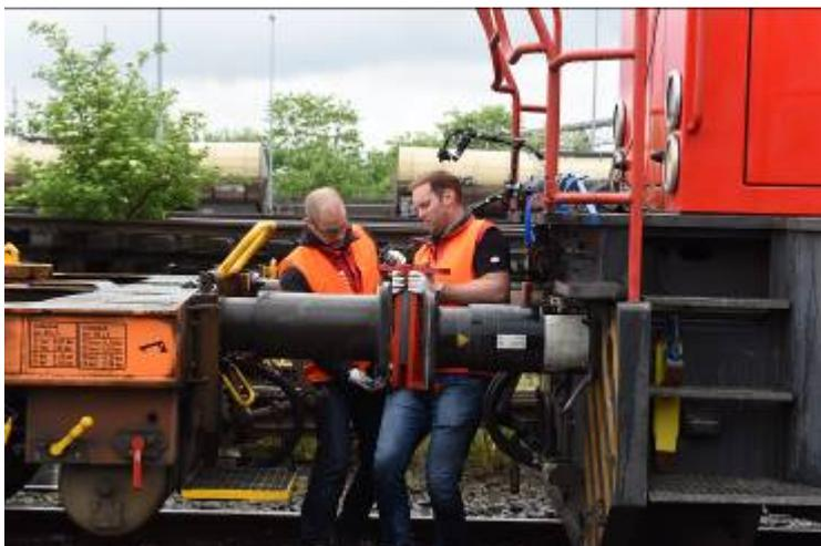
Nachdem die Klebung rund 45 Minuten lang aushärten konnte, wurde sie mit Kupplungsaufbau der Zuggarnitur verbunden.
