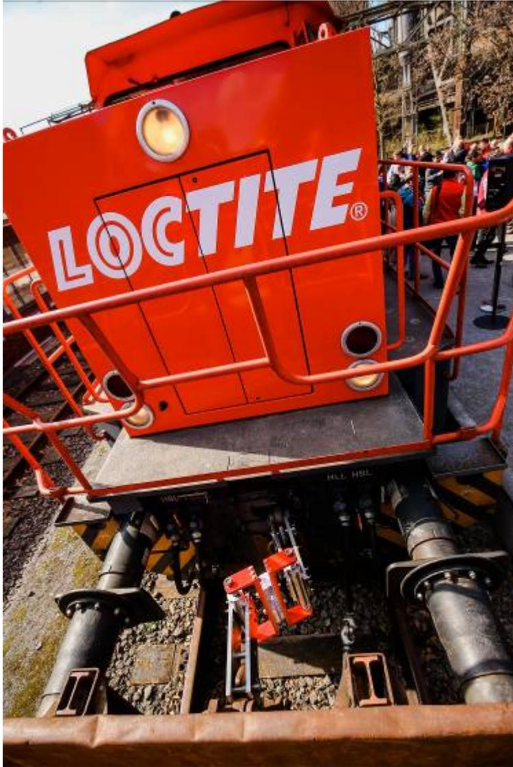
Die Lokomotive zog den nur über die Klebeverbindung befestigten Zug über das Henkel-Werks Gelände.
