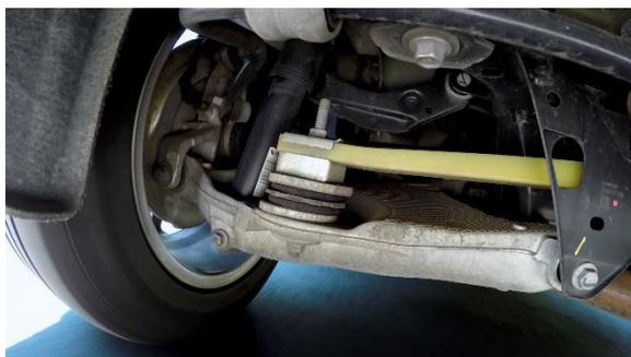
In den aktuellen Volvo-Modellen der 90er-Baureihen spart die Blattfeder 4,5 Kilogramm Gewicht im Vergleich zu herkömmlichen Stahlschraubenfedern.
