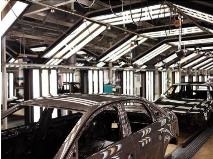
Patentierter Bonderite Zwei-Stufen-Prozess von Henkel zur Oberflächenbehandlung von Karosserien bei Audi.
