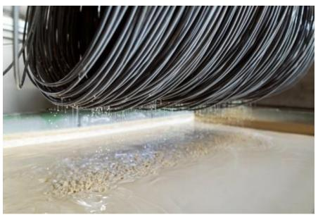
Bonderite L-FM FL ist eine nicht reaktive, wasserbasierte Polymerbeschichtung, die einen besonders nachhaltigen Oberflächenkonversionsprozess ermöglicht.
