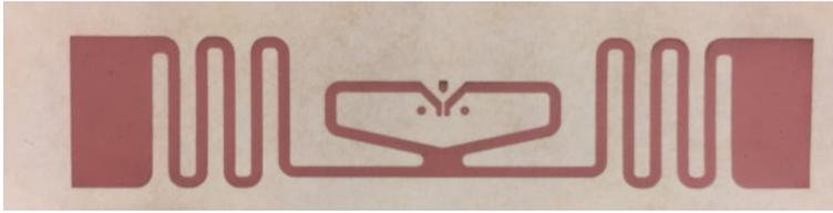
Die kupferbasierten Tinten von Copprint haben bereits die technische Produktqualifizierung für gedruckte RFID-Antennen erhalten.
