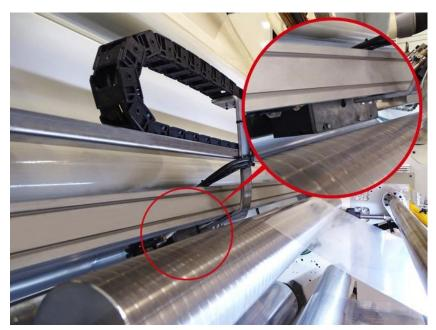
Der Sensor erfasst den Isocyanatgehalt und sorgt so für höchste Präzision in der Auftragsgewichtsmessung
