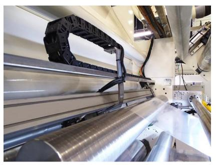
Lioscan verfügt über einen automatisch oszillierenden Infrarotsensor, der sich ohne jeden Materialkontakt quer über dem Film bewegt
