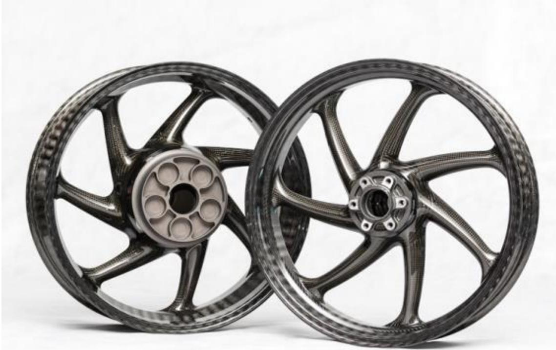
thyssenkrupp Carbon Components hat vor Kurzem mit Loctite MAX5 eine neue Generation ultraleichter geflochtener Carbonfelgen für Motorräder eingeführt.
