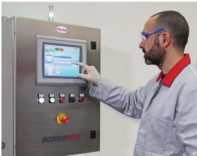
Il controller Bonderite E-CO DMC possiede un touch screen intuitivo e una memoria interna per conservare un numero virtualmente illimitato di parametri di processo nelle linee di trattamento dei metalli fino a 15 stadi e oltre. (Foto: Henkel, PR060)
